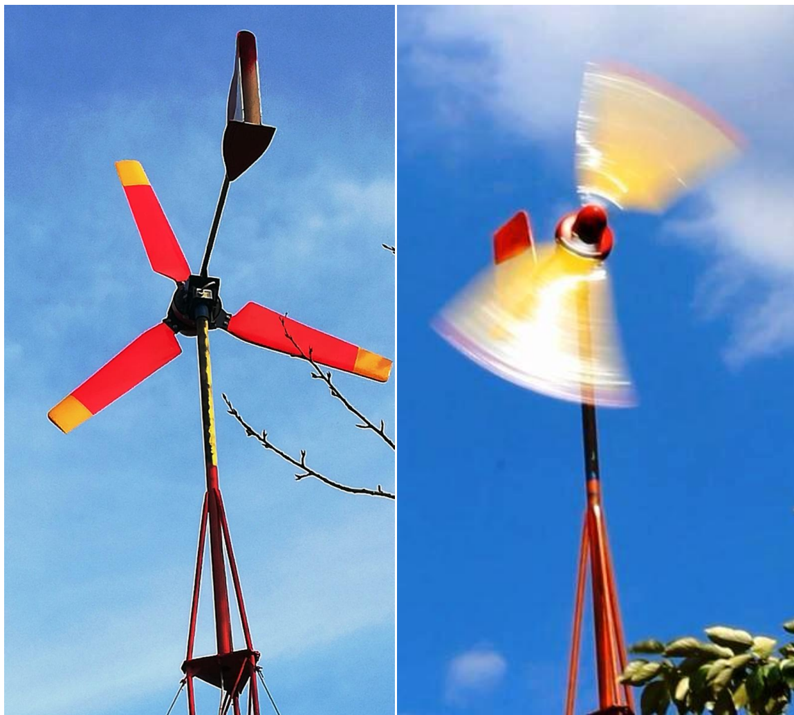
Turbínka RENEN160 v trojlistovom vyhotovení (vľavo) a dvojlistovom (vpravo)
